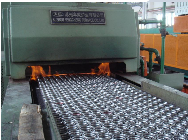
Ligne de traitement thermique
